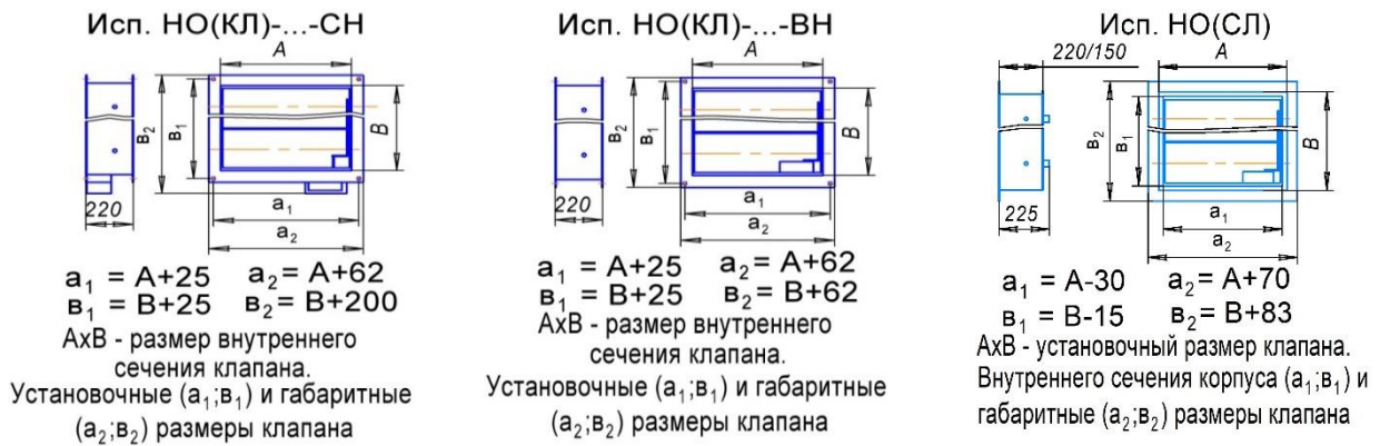
Рис.1. Установочные, габаритные и размеры внутреннего сечения клапана.
